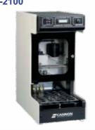
вязкость МОТОРНЫХ МАСЕЛ ПРИ ВЫСОКОЙ Т° И ВЫСОКОЙ СКОРОСТИ СДВИГА
