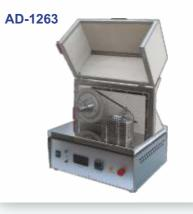
ТЕМПЕРАТУРА КАПЛЕПА-ДЕНИЯ ПЛАСТИЧНЫХ СМАЗОК В ШИРОКОМ ДИАПАЗОНЕ
