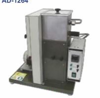
СКЛОННОСТЬ СМАЗОК К УТЕЧКЕ из автомобильных подшипников
