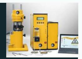
Крутящий момент: 0,1...150 мНм Разрешение: 0,002 мНм Скорость: 0 ... 2000 об/мин Разрешение: 0,015 об/мин Диапазон вязкости 1 ... 3\*10° мПа Диапазон температур: RN 4.3: -15 ... +180 °C RN 5.3: -10 ... +150 °C
