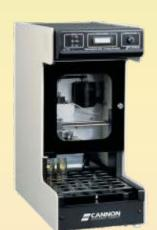
Автоматические имитаторы холодной прокрутки двигателя моделей CCS-2100, CCS-2100-LT
