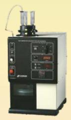
Автоматический 5-местный капиллярный вискозиметр для испытаний при высокой температуре и высокой скорости сдвига определение вязкости моторных температуры прокачиваемости асфальтовых связующих масел в условиях высокой температуры (стандартно +150±0,1°С) и высокой скорости в диапазоне температур сдвига (стандартно  $1,4x10^6c^{-1}$ ). Производительность:
