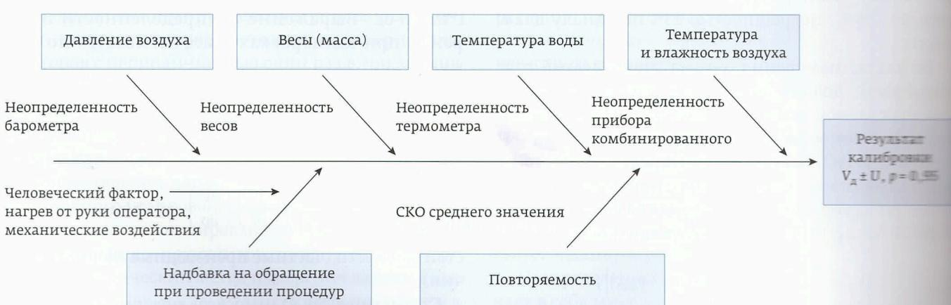
Рис. 1. Причинно-следственная диаграмма. Источники неопределенности измерений при калибровке лабораторных дозирующих устройств
